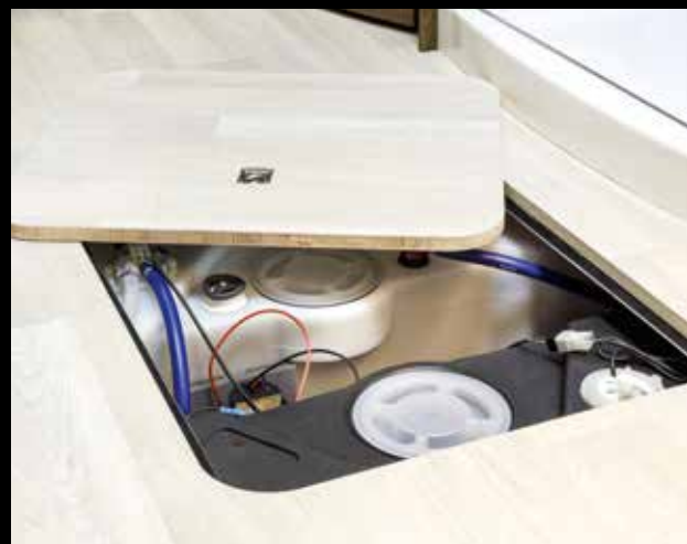
Durchgängig stufenloser FRANKIA Doppelboden von außen und innen zugänglich
